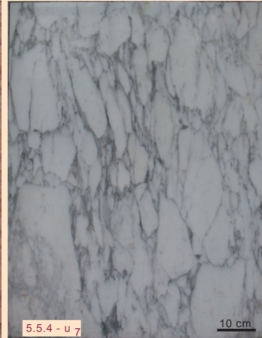
Abb. 5.5.4 - u 7: Arabescato , einer der Jura- Marmore aus der Umgebung von Carrara, Italien; charakteristisch ist das Mosaik von Bruchstücken.
