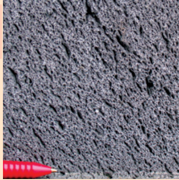
Abb. 1.2 c Vulkanisches Gestein >> Mendiger Basaltlava mit Blasenzügen entwichener Gase, Erweiterungsbau, Neuer Eingang, Sockel (5.3.2)
