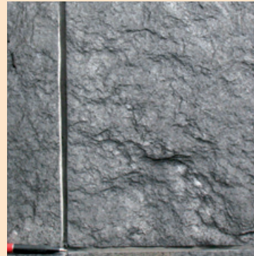
^ Abb. 1.2 e Sedimentgestein: Kirc hheimer Muschelkalk Gold- bank , Kalkstein, Erweiterungsbau, Aufgang B.ostfachbereich (5.3.5)
