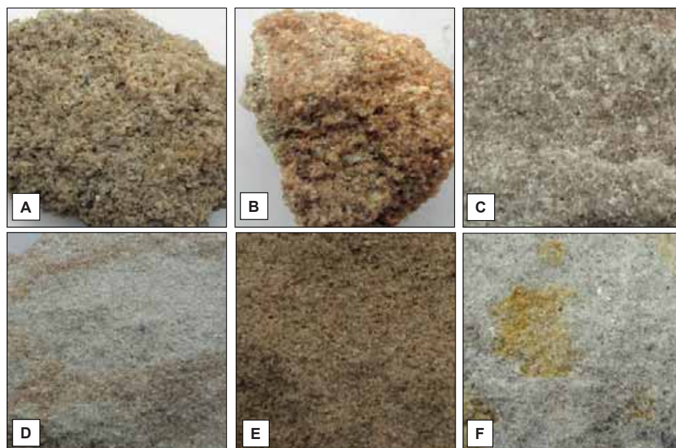
Abb. 2: Sandsteintypen vom Burgberg (Fotos R. Koch; Bildbreite = 4 cm); A – grobkörnig, braun, schwach verfestigt; B – rötlich-braun, schwach verfestigt; C – mittelkörnig, grau, stark verfestigt; D – feinkörnig, weißlich-rötlich, schlierig, gut verfestigt; E – feinkörnig, braun, gut verfestigt; F – fein- bis mittelkörnig, weiß-fleckig, mäßig verfestigt.
